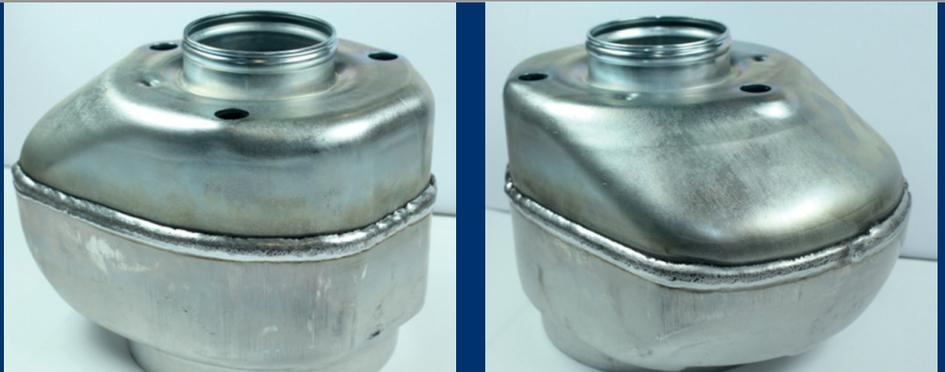
*Demonstrator in Multimaterialbauweise: Die obere Hälfte besteht aus Stahl, die untere aus Aluminium.*
